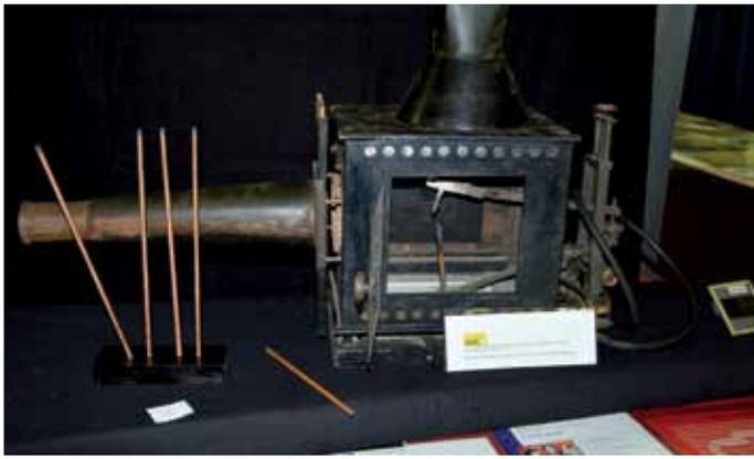
Lanterna per diapositive professionale manuale di fine '800 - inizi '900, funzionante con elettrodi a carbone
