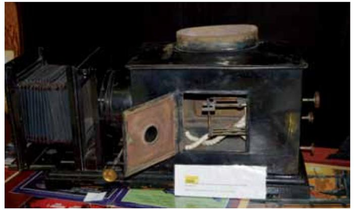
Un'altra lanterna per diapositive professionale manuale, funzionante con elettrodi a carbone, datata primi del '900
