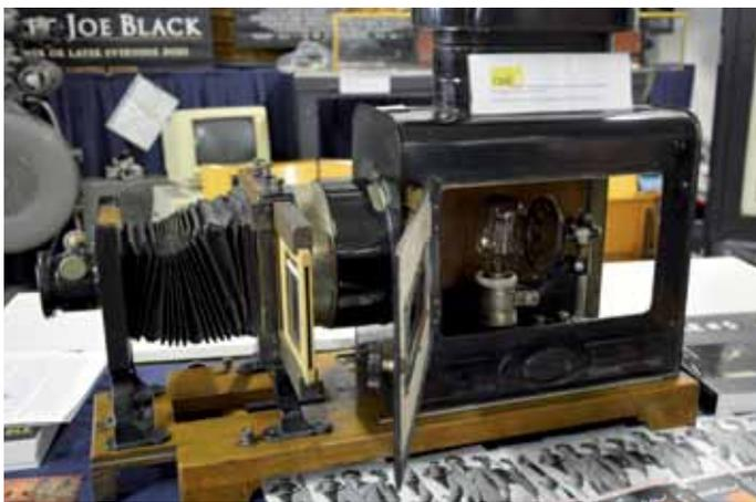
Un'altra lanterna per diapositive risalente ai primi del '900 ma modificata con l'utilizzo di una lampada a filamento
